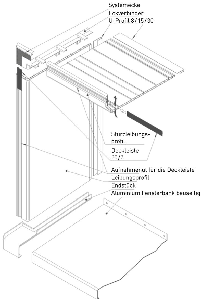
Für die Entlüftung der Fassadenfläche unter der Fensterbank muss zwischen der Oberkante des vinylBoard Profils und der Unterkante der Fensterbank ein Spalt von mindestens 20 mm belassen werden. Um Verschmutzungen der Fassadenoberfläche zu vermeiden, empfehlen wir einen Fensterbanküberstand von 3 – 4 cm und den Einbau von Fensterbankendstücken (Art.-Nr.: 0 63 60 \_\_).
