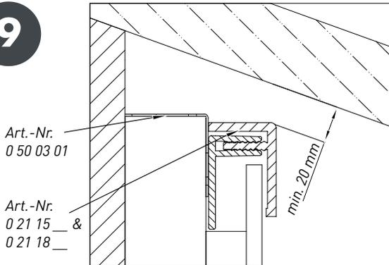
Auch die Zubehörprofile unterliegen bei Temperaturerhöhungen einer Wärmeausdehnung. Es ist unbedingt darauf zu achten, dass an den Profilenden zu anderen feststehenden Bauteilen genügend Raum für die Ausdehnung vorhanden ist. Die Oberteile von senkrecht montierten 2-teiligen Zubehörprofilen sind gegen Abrutschen im oberen Bereich, z. B. mit Montagekleber oder Schrauben, zu fixieren.
